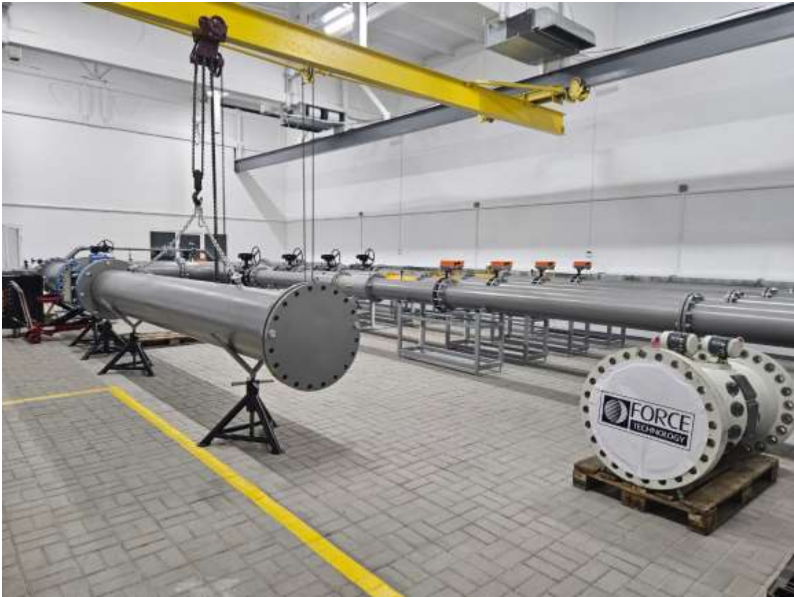
Рисунок 3 – Робочий еталон одиниць об'єму та об'ємної витрати газу в діапазоні об'ємної витрати від 1 до 25000 м 3 /год
